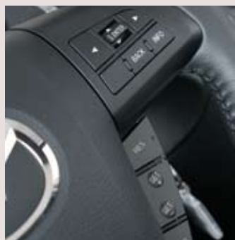
Руль Мазды 3 оброс кнопками пульта управления системой CF-Net, а клавиши круиз-контроля разместились между спицами
