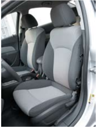
Подушка водительского сиденья Круза слишком мягкая, а наклон спинки регулируется ступенчато и неудобно — левая рука с трудом пролезает между сиденьем и стойкой, а правой в это время приходится наклонять слабо подпружиненную спинку
