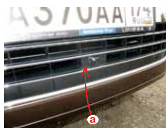
За решеткой радиатора размещена камера фронтального обзора (а)
